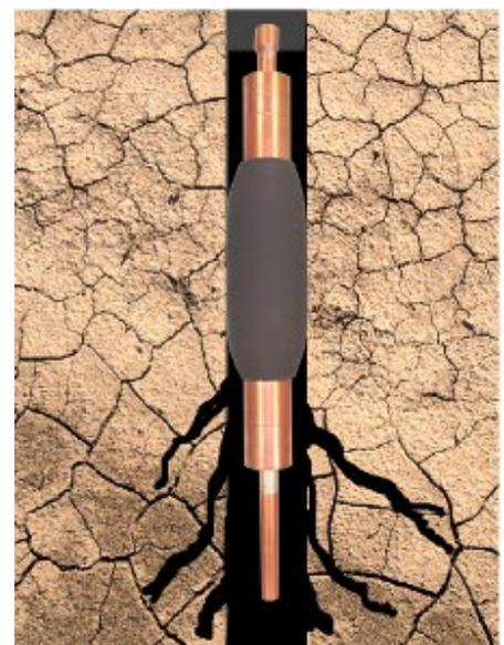
I packer gonfiabili o "Otturatori" Geopack sono utilizzati per l'iniezione di cemento in pressione in fori liberi, micropali valvolati e/o tubi PVC con "manchettes", tubi in vetroresina in applicazioni geotecniche per la stabilizzazione e/o l'impermeabilizzazione di fondazioni, tunnel e altri lavori di consolidamento. I due metodi di utilizzo sono:
